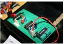
SpeakJet-IIC-Module Breadboard v1.3
