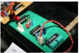
SpeakJet-IIC-Module Breadboard v1.3
