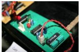
SpeakJet-IIC-Module Breadboard v1.3
