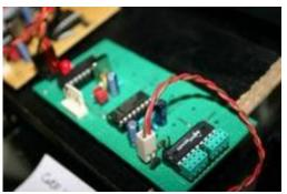
SpeakJet-IIC-Module Breadboard v1.3
